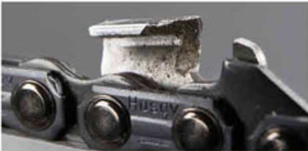
锯过石头的切面显示切口顶层损坏处的不规则边缘。应锉下所有损坏处，以确保良好的尖锐度。
