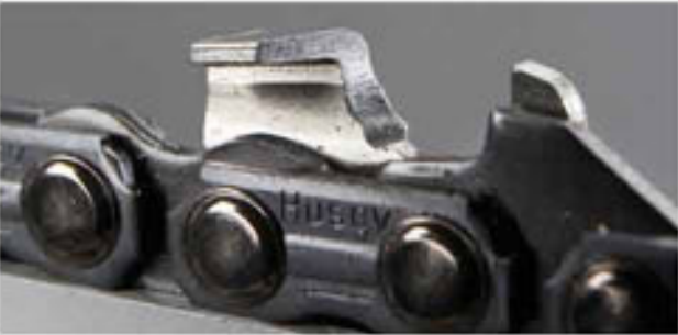
向后倾斜角。切割齿磨挫太多，使其切割效率下降。 使用深度规并根据操作指南重新磨锉切面。
