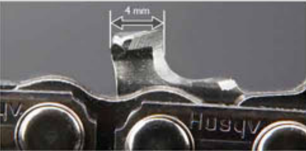
当锯齿的最长部分小于 4 mm，时或发现裂缝的情况下，则可更换链条。
