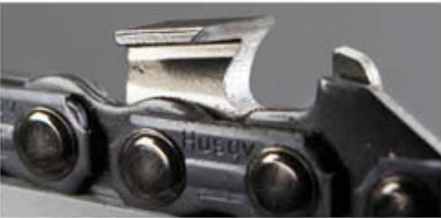
侧板修磨角度过小形成的钩状锯齿。
