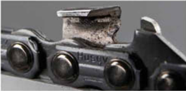
锯切木材正常磨损的锯齿，需要进行修磨，请注意切面的“白色”边缘。
